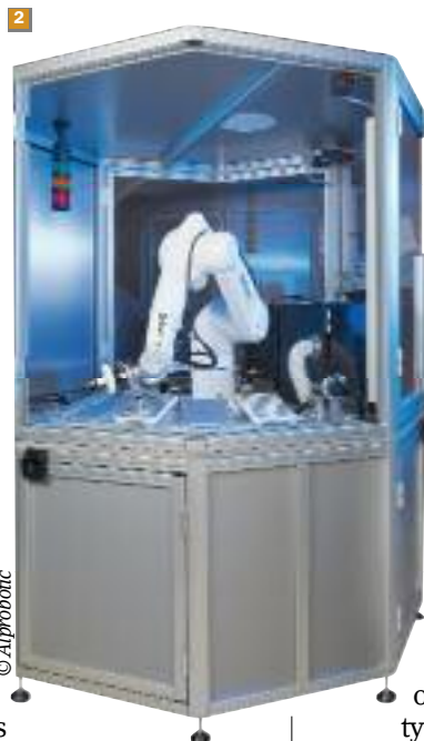
1 La cellule d'anodisation avec les différents bains de traitement en arrière-plan et le convoyeur devant l'opérateur. 2 La cellule de microbillage d'implants chirurgicaux.
