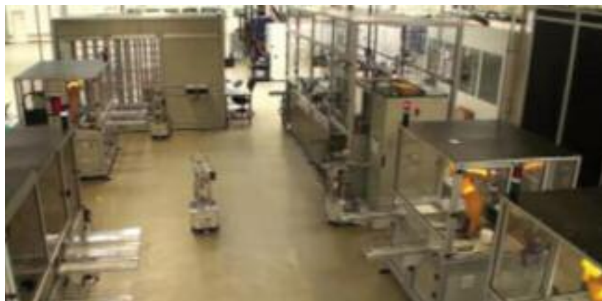
Une vue d'ensemble d'un atelier de finition avec au fond un robot mobile qui alimente le magasin de stockage automatisé en arrière-plan. L'autre robot est au milieu de l'atelier.
